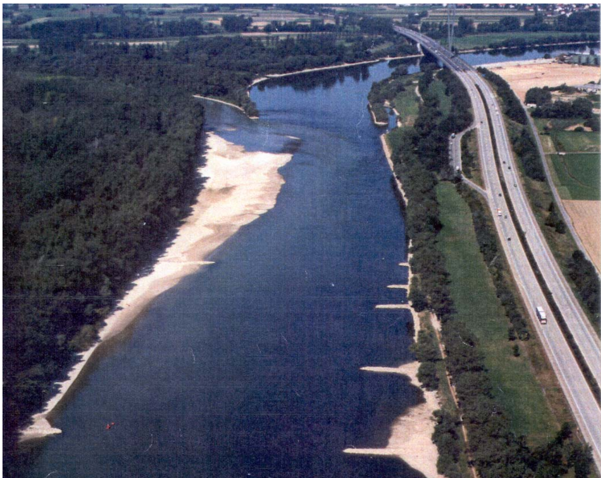
Bild 2: Geschiebeschüttkegel im Bereich der Isarmündung
