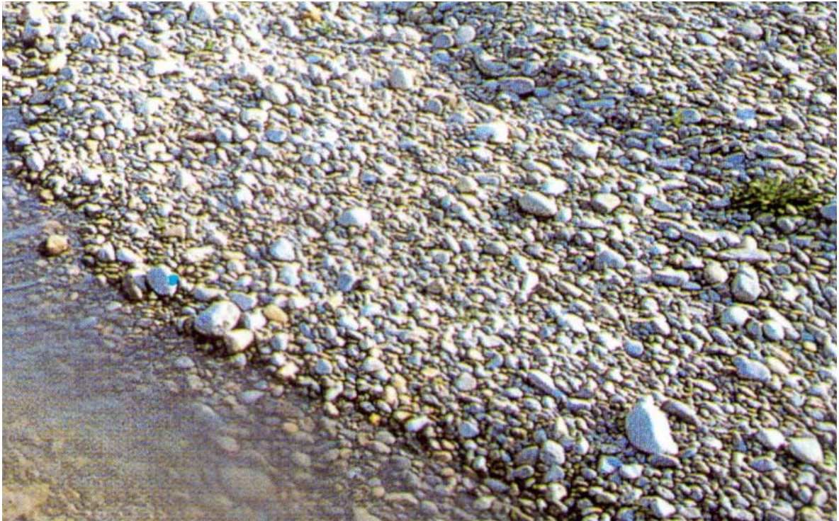
Gut durchmischte Kornzusammensetzung mit einzelnen Grobkörnern
